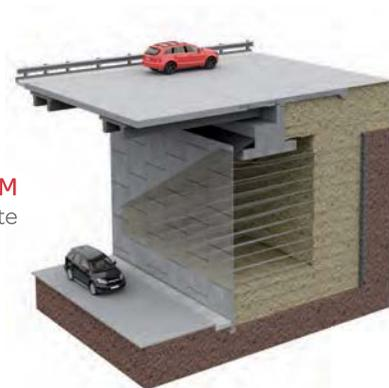
Corte tipo Muro TEM como estribo de puente
