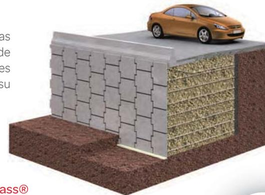
**Corte tipo Muros TerraClass®**
